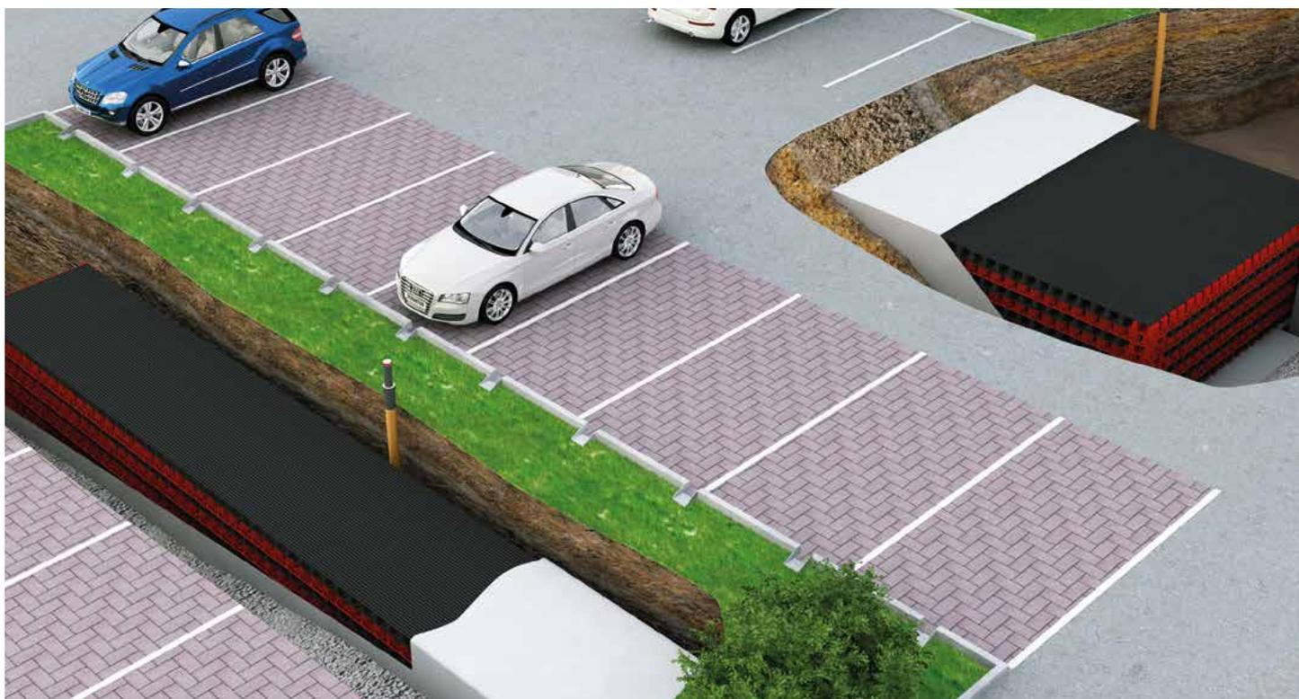
Modulares, besonders strapazierfähiges System zur Errichtung von drainierenden Becken oder Sammelbecken mit großem Fassungsvermögen.
