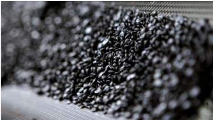
Figura 5 - Gránulos de polipropileno regenerado
