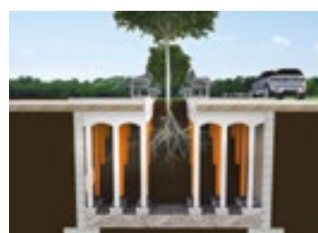
Querschnitt des NEUE Elevator-Root-Systems
