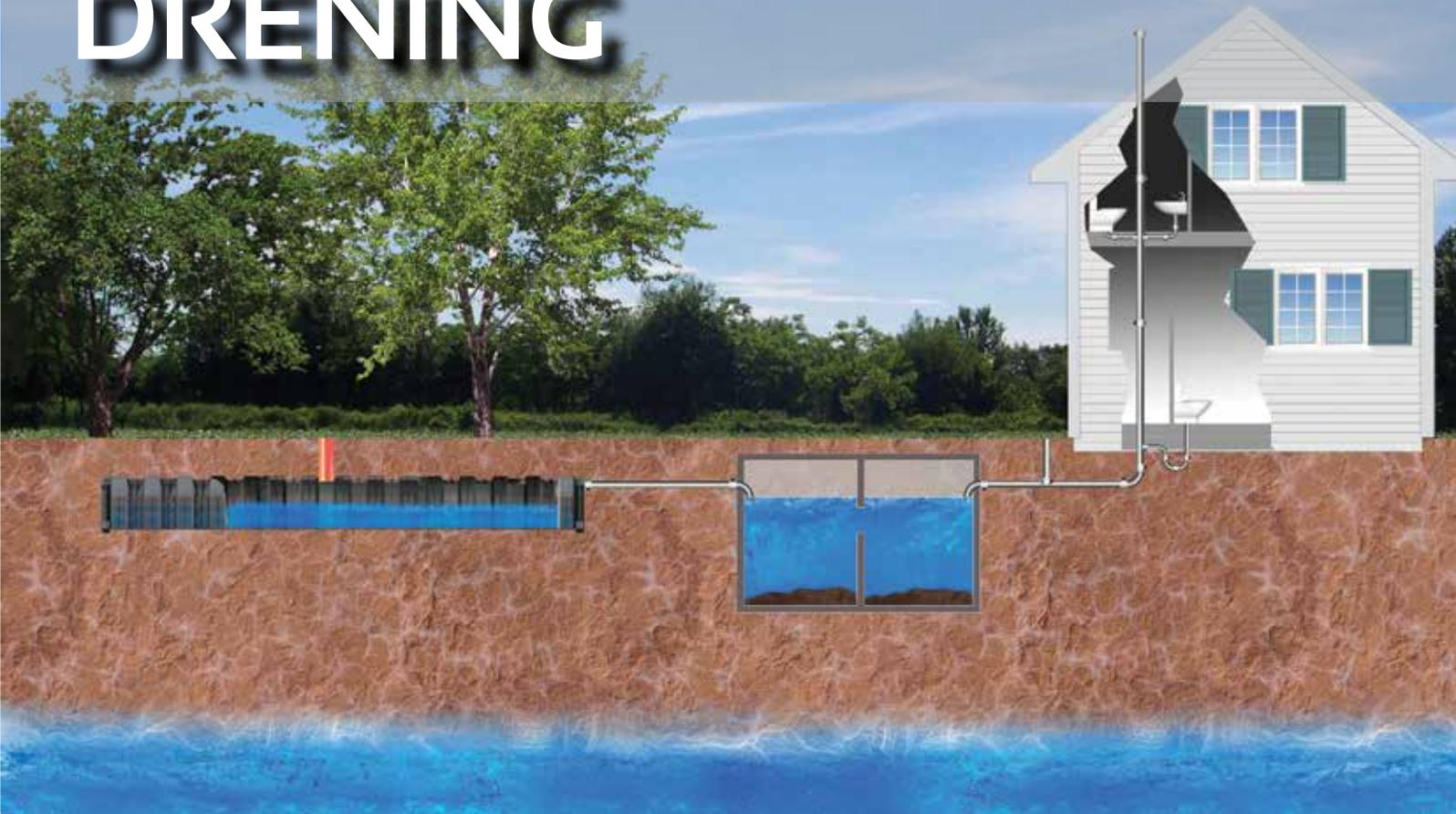
Sistema modulare ad alta resistenza per la creazione di bacini drenanti ad elevata capacità di accumulazione
