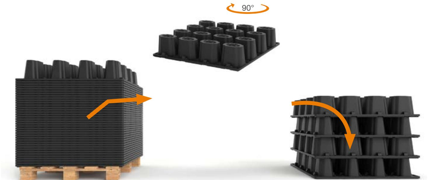
Le design innovant de DRAINPANEL permet d'empiler facilement les éléments (disposés dans la même direction), et ça minimise l'encombrement pour le stockage et le transport du matériau, en permettant la création de volumes de stockage élevés, qui peuvent être obtenus simplement par la pose des éléments tournés de 90° dans les différentes couches.
