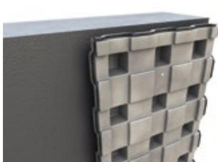
Près de la bordure du plancher fixer le panneau supérieur avec un goujon (de préférence chimique et pas mécanique).
