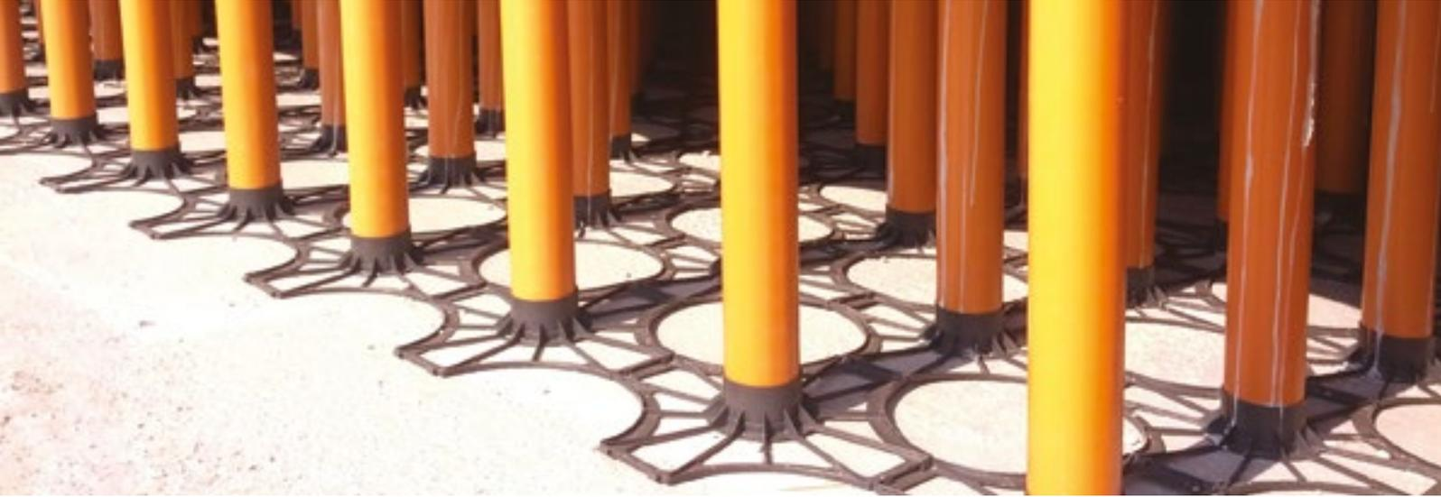
NOUVEAU ELEVETOR est la solution de coffrage idéale pour les vides sanitaires en béton armé. Le procédé est adapté à tout type de construction: logement, bâtiments commerciaux et industriels. Le système se compose de caissons qui forment le fond de coffrage de dalle, de tubes en PVC pour les verticaux et d'une grille brevetée qui assure la stabilité au système et donc sa excellente capacité de charge.
