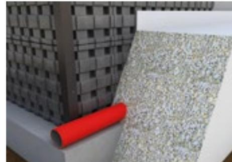
Avant de remettre le sol naturel versez dans un tuyau de drainage du gravier, puis posez au-dessus le géotextile.
