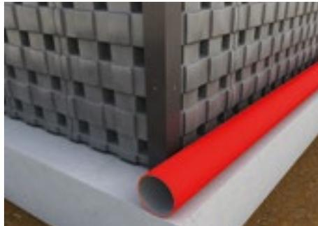
Le long de tout le périmètre du bâtiment et proche du mur, placer un tuyau de drainage qui débouche dans un bassin de drainage.
