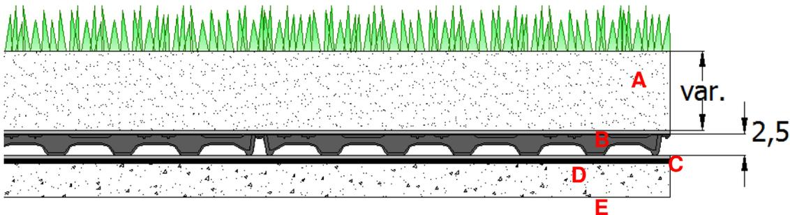
A- A- Substrat; B- Géotextile de séparation; C- Lapillus volcanique; D- Drainroof H2,5; E- Gaine et géotextile de protection; F- Plancher
