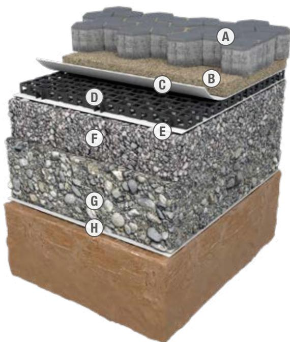
Figura 1 - componenti del sistema Geocell
