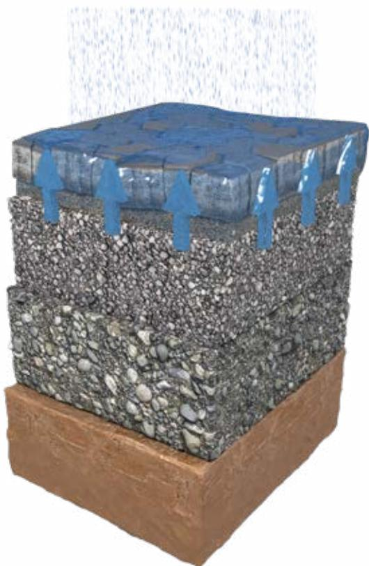
Figura 21 - sottospinte idrauliche agenti sulla superficie a betonelle SENZA Geocell
