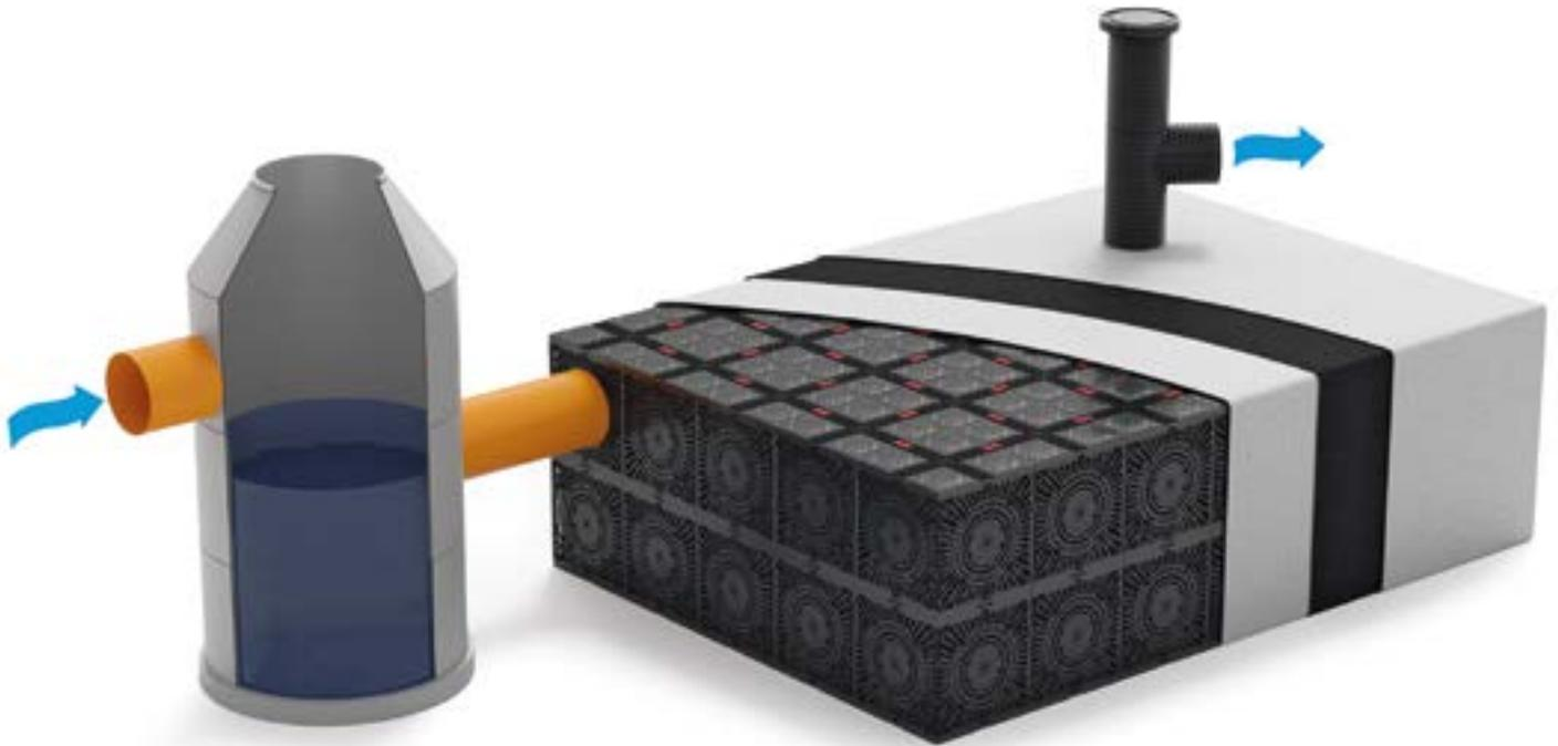
L'eau de pluie qui s'écoule des toits ou d'autres surfaces et qui est collectée pour être réutilisée est toujours canalisée par une étape de prétraitement appropriée avant d'entrer dans le réservoir.
