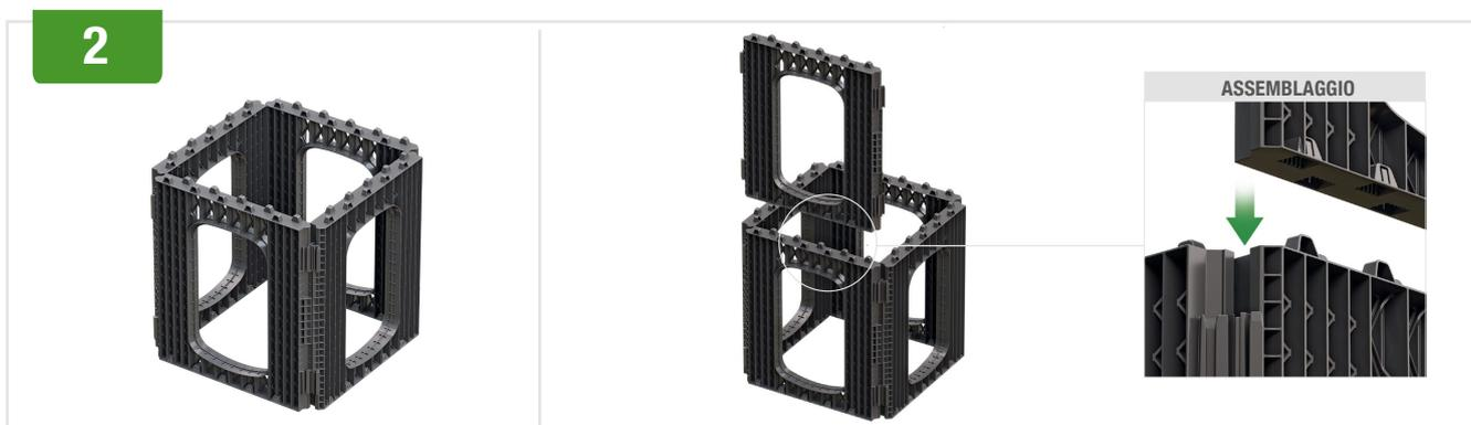
Proseguire con lo stesso metodo di incastro con gli altri componenti verticali fino a chiudere i moduli Rootbox, che sono ora autoportanti. Continuare alla stessa maniera per proseguire con l'installazione del primo livello di Rootbox. In questa fase si può iniziare l'installazione gli impianti di irrigazione, aerazione o altro.
