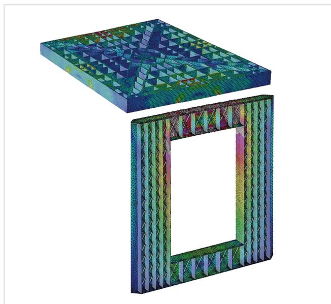
*Analisi FEM del comportamento degli elementi e dell'assemblato sotto carichi di esercizio.*
