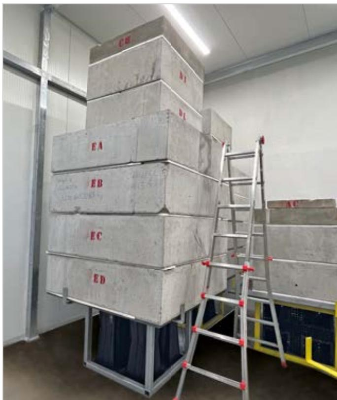
*Provini di calcestruzzo per prova di carico Aquabox*
