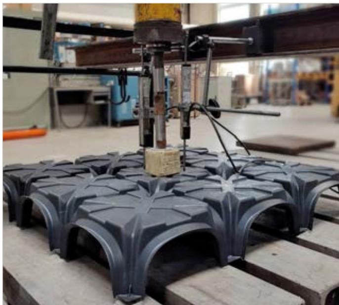
*Prova di carico Modulo*
