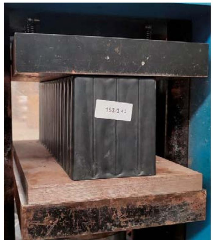
*Test di resistenza del nuovo elemento in polipropilene*
